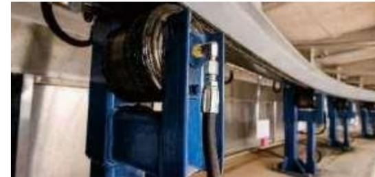
Автоматическая система смазки двутавровой балки
