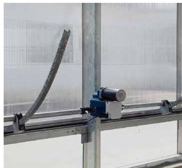
Система речной вентиляции
